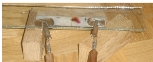
Rys. 3.1.2 Przepływ prądu w elektrolicie. Krysztalki nadmanganianu potasu przed włączeniem prądu (po lewej) i po odpowiednio długim trwającym przepływie prądu (po prawej)
