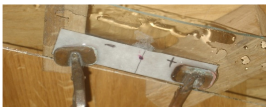
Rys. 3.1.2 Przepływ prądu w elektrolicie. Krysztalki nadmanganianu potasu przed włączeniem prądu (po lewej) i po odpowiednio długim trwającym przepływie prądu (po prawej)
