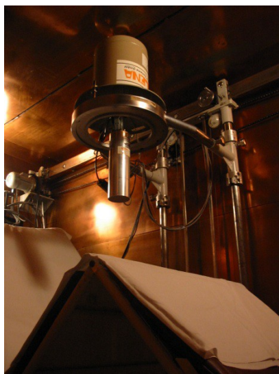
Rys. 6.1. Kabina licznika promieniowania całego ciała w Narodowym Centrum Badań Jądrowych
