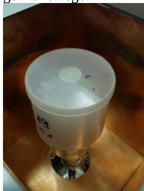
Rys. 7.2. Pomiar skażeń gleby – próbka gleby w pojemniku Marinelli mierzona sondą germanową.
